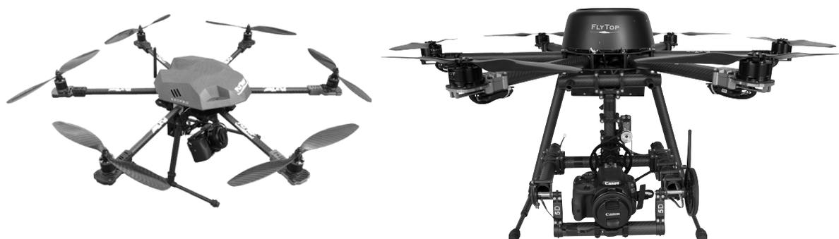
**Fig. 2** – APR multirotori ad ala rotante (in questo caso trattasi di esacotteri).
