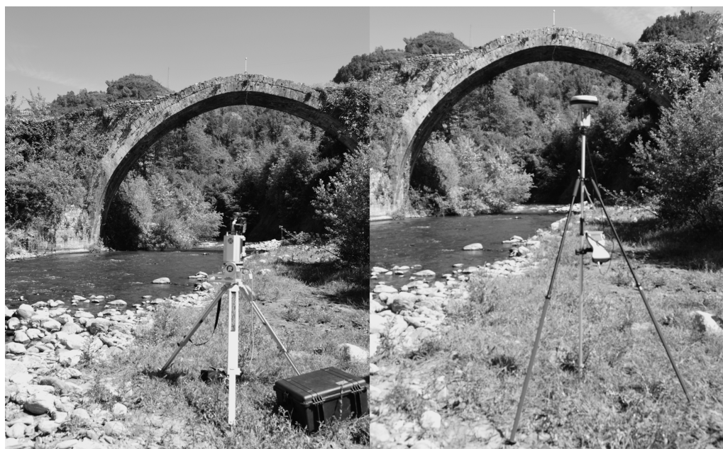
Fig. 2 - Rilievo del Ponte di Annibale con Laser Scanner e ricevitore GNSS
