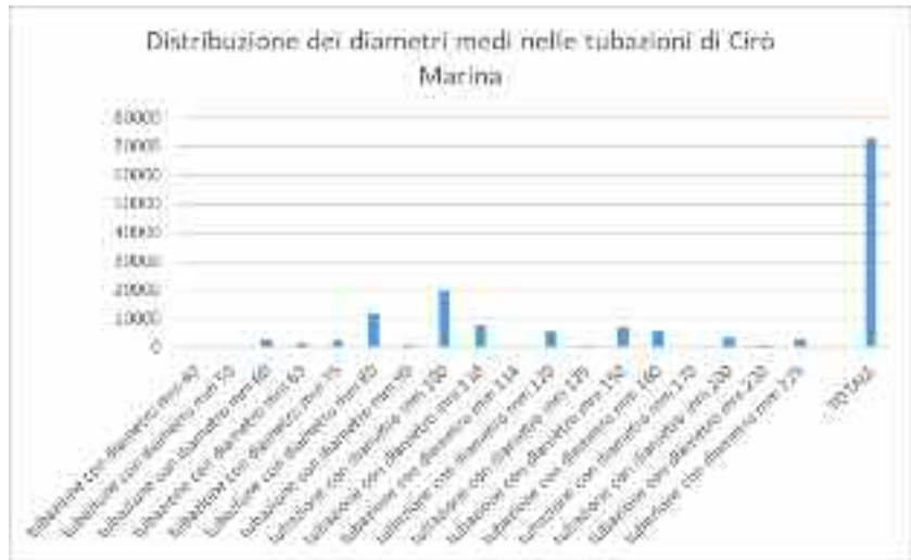
Figura 5. Distribuzione dei diametri delle tubazioni nel comune di Cirò Marina. Sui 911 tratti di tubazione del territorio comunale è stato possibile inoltre definire la distribuzione dei materiali utilizzati (fig. 6) dalla quale è stato possibile evidenziare come la ghisa sia il materiale predominante presente nelle condotte di Cirò Marina, presente per più della metà (57%)
