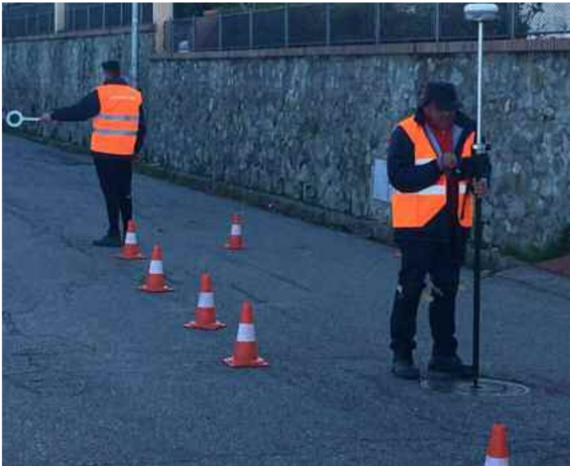
Figura 2. Rilievo puntuale pozzetti idrici con GPS
